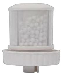
В комплект прибора входит фильтр с ионообменной смолой. При длительном использовании увлажнителя без замены смолы на приборе и на предметах рядом с ним может появиться белый осадок. Белый осадок – это кальций и магний, которые входят в состав обычной водопроводной воды. При отработке ресурса ионообменной смолы в фильтре они выпускаются вместе с паром и оседают на окружающие предметы и поверхности.
