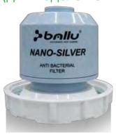
В комплект прибора входит фильтр с ионообменной смолой. При длительном использовании увлажнителя без замены смолы на приборе и на предметах рядом с ним может появиться белый осадок. Белый осадок – это кальций и магний, которые входят в состав обычной водопроводной воды. При отработке ресурса ионообменной смолы в фильтре они выпускаются вместе с паром и оседают на окружающие предметы и поверхности.
